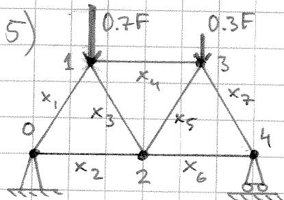
Lös problemet med fackverket från uppg. 4, frs v39! Sätt  $F = 1$ , så blir dragkrafterna  $x_i$  multiplar av F. Vilket steg i fackverket har största drag- resp. tryckekrafter? (Dessa borde kanske förstärkas, medan steg med små drag- eller tryckekrafter kanske ersättas med svagare (och därmed förhoppningsvis billigare) steg.)
