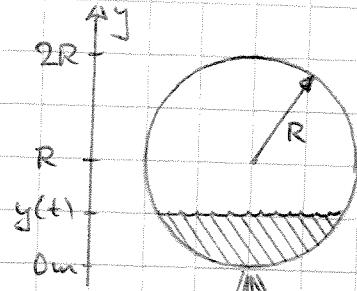
I1. Vi tillverkar ett rotationssymmetriskt vattenur med tvärsittsprofilen som i fig. f.l.n.
