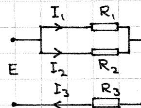
$$I_1 = ER_1 / (R_1 R_2 + R_2 R_3 + R_3 R_1). \text{ Om } E = 40 \text{ V}, R_1 = 1.00 \pm 0.04 \text{ k}\Omega, R_2 = 2.00 \pm 0.01 \text{ k}\Omega \text{ och } R_3 = 6.00 \pm 0.05 \text{ k}\Omega, \text{ så är } I_1 \approx 4 \text{ mA.}$$
