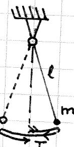
Svartar bygger en pendel för att approximera  $g$ . Han uppmäter  $l$  till  $1.00 \pm 0.03 \text{ m}$  och  $T$  till  $2.00 \pm 0.05 \text{ s}$ . Detta ger honom att  $g \approx \pi^2 \text{ m/s}^2$  ( $\approx 9.87 \text{ m/s}^2$ ). Använd differentialekvationen till att beräkna en approx. över gräns för osäkerheten i approximationen  $g \approx \pi^2 \text{ m/s}^2$ , som osäkerheterna i  $l$  och  $T$  ger upphov till. (Jämför även med isokrona pendeln i uppg. 3, fr v7.)
